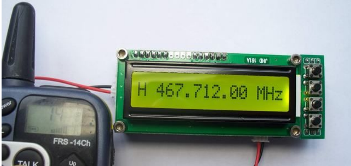
测量 450 MHz 对讲机的频率
