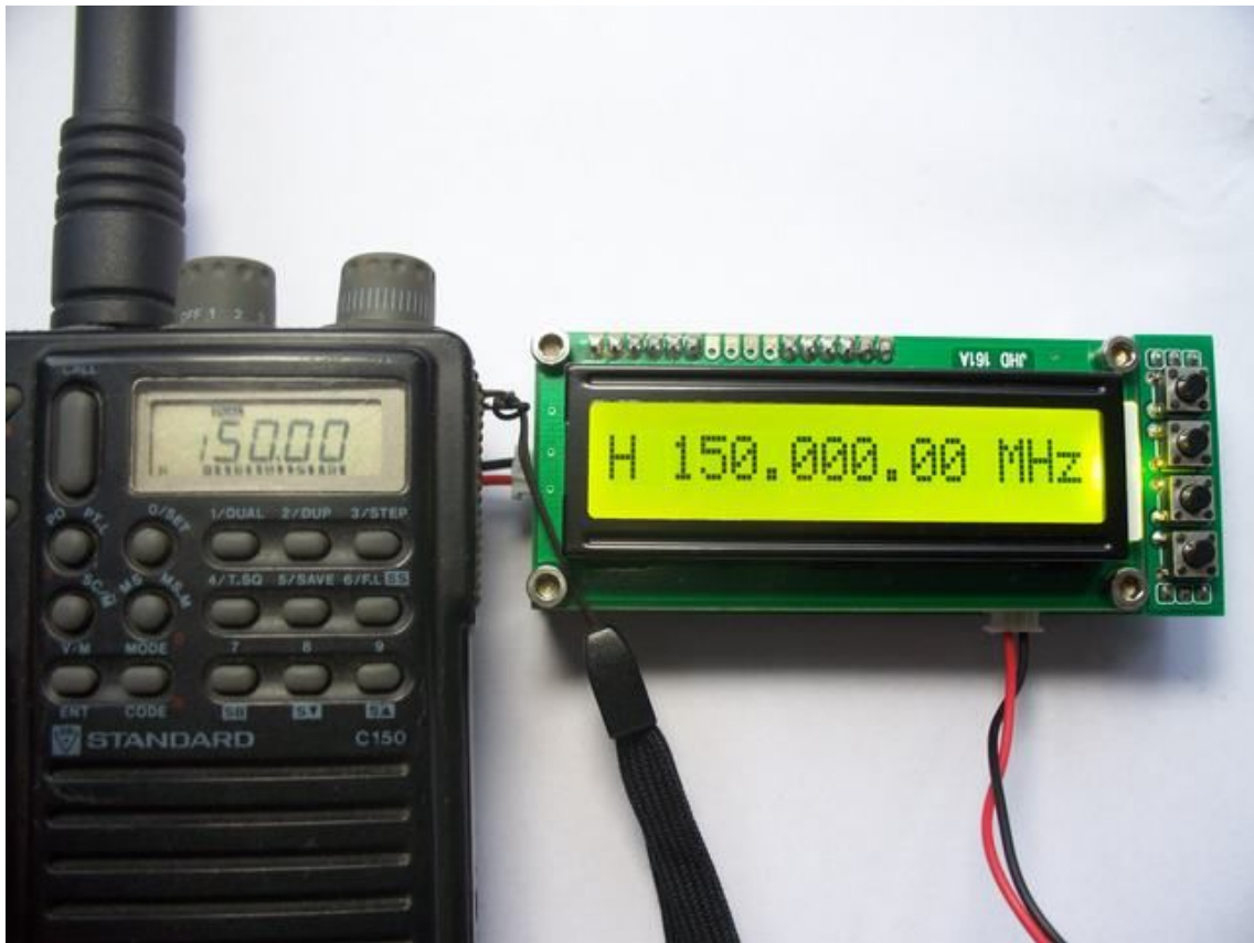
测量 150 MHz 对讲机的频率
